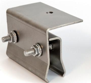
Speziell für die Montage auf Domico-Falzdächern ist diese Klemme geeignet. Sie wird, wie alle Falzklemmen aus Edelstahl gefertigt und ist ca. 35 % leichter als eine vergleichbare Klemme aus Aluminium. Alle Klemmen verfügen über zwei Schrauben zur Befestigung am Dach und ein Rundloch mit 9 oder 11 mm zur Befestigung der Montageprofile.
